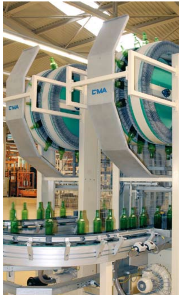
Glaswender mit Ausblasung und/oder Vibrationsleiste
