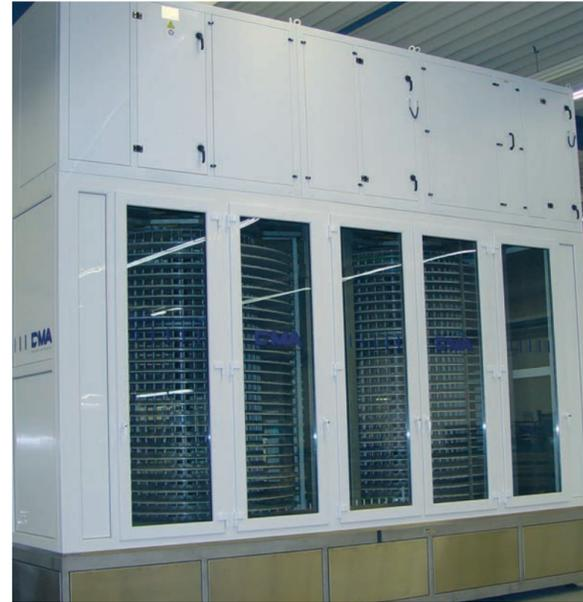
Das Kühlaggregat wird je nach Platzverhältnissen und Anforderung vor, zwischen oder oberhalb der Kühlspiralen verbaut.
